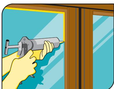
**Tekasil Acetat** Trajnoelastična tesnilna masa na acetatni osnovi z odličnim oprijemom na večino silikatnih materialov (aluminij, keramika, steklo, glazirane površine, profilirano steklo, klinker, porcelan itn.).
