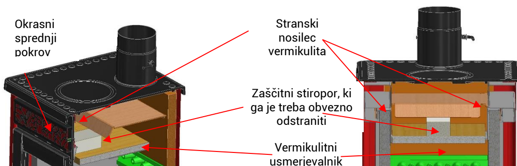
Slika 3. Demontaža stiropora in montaža vermikulita
